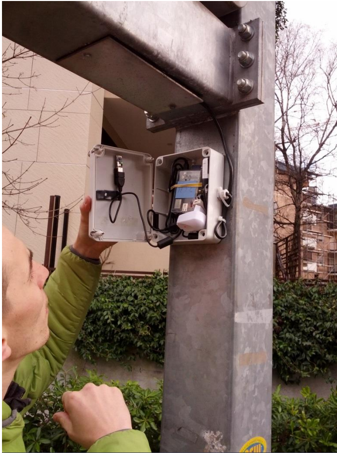
Abbildung 4: Einer der Bluetooth-Detektoren auf Bozens Straßen.
