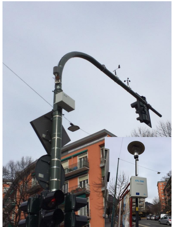
Abbildung 3: Die neue Station zur Messung der Luftverschmutzung in der Romstraße.
